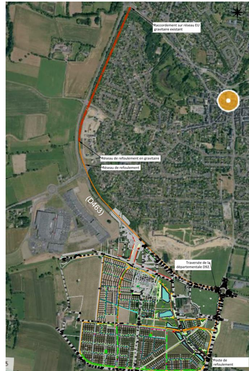
Réseau de Refoulement des eaux usées
