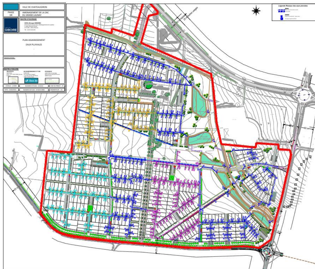
Carte de synthèse réseaux eaux pluviales
