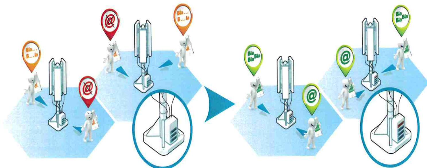
Face à l'explosion des usages en très haut débit mobile (internet, applications), l'antenne actuelle n'est plus en mesure d'assurer un écoulement fluide des communications. Ainsi, Bouygues Telecom envisage un renforcement de ses éléments techniques de transmission de données pour l'apport ou l'amélioration de la technologie 4G, par exemple.
